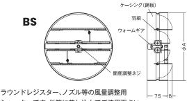
シャッターです。単管に差し込んでご使用下さい。 (註)RHV.NR.NT.NPのサイズ20"、24" を使用する 場合の単管内径は、 $508\phi$ 、 $609\phi$ にして下さい。
