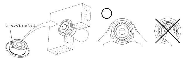
◇ダクト挿入時に中央部分を押すと動きますので、 市販のシーリング材を差込部のつけ根部全周に塗布します。 額縁付近を押さえるように入れて下さい。
