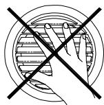
◆ダクト挿入時にガラリや網等の弱い部分を押すと製品が変形してしまいますので、額縁付近を押さえるよう入れて下さい。
