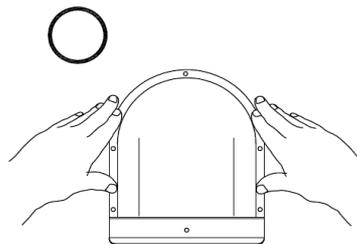
◇ダクト挿入時にガラリや網等の弱い部分を押しと製品が変形してしまいますので、額縁付近を押さえるように入れて下さい。
