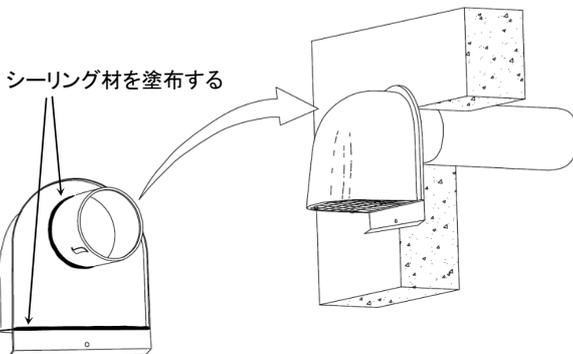
1. 市販のシーリング材を、(1)差込部のつけ根部全周、(2)水切部のつけ根、に塗布します。
